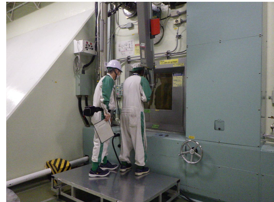
せん断粉末の取出しに係る遠隔操作の様子 (マニプレータによるせん断粉末の移動操作)
