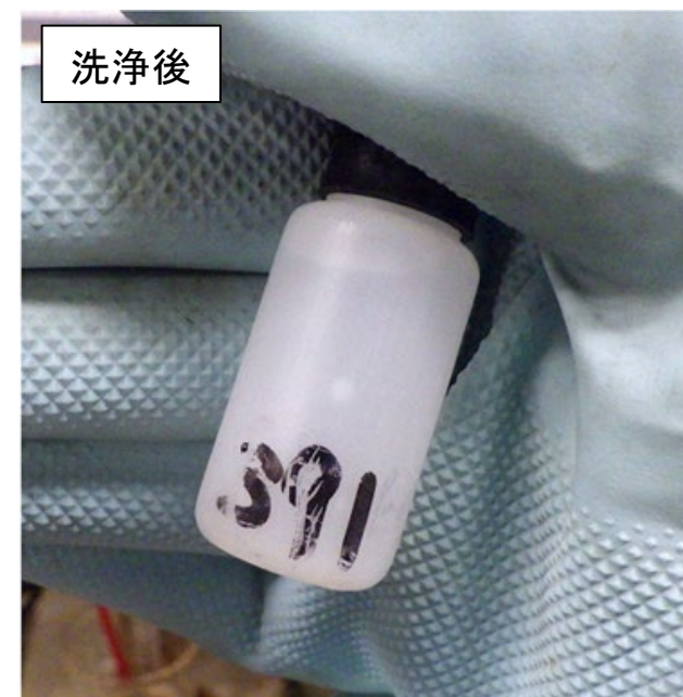
工程洗浄の進捗に伴うリワーク工程の プルトニウム溶液受槽内溶液の状態 (Pu濃度の低下による色の変化)
