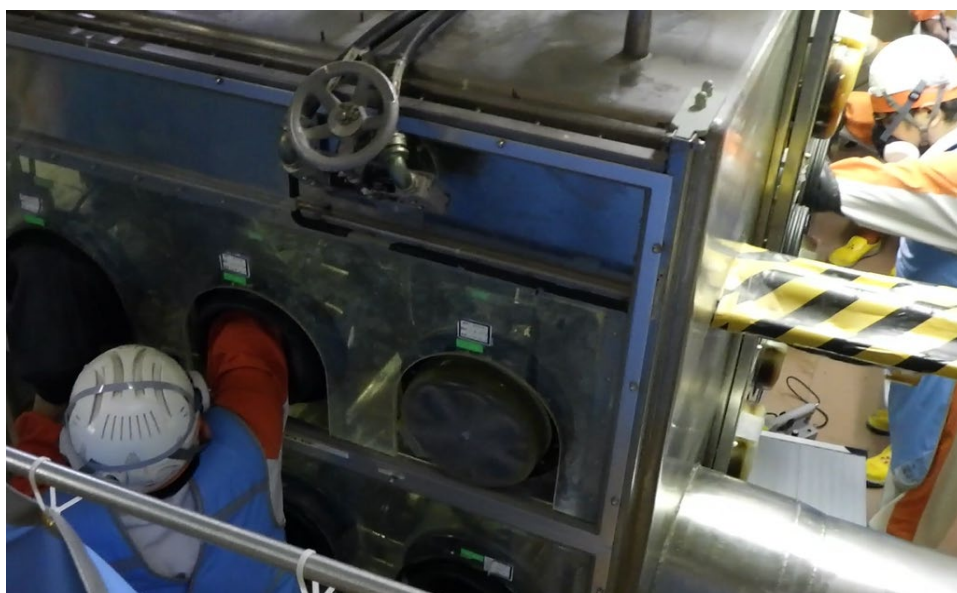
低濃度のプルトニウム溶液取出しに係る操作風景 (グローブボックス作業による低濃度のプルトニウム溶液の移送操作)
